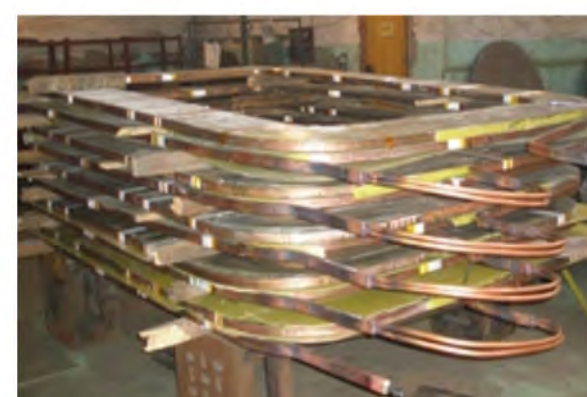
线圈制作 Coil making
