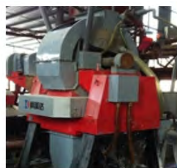
广东河源长石除铁 Iron remove of feldspar in Heyuan Guangzhou
